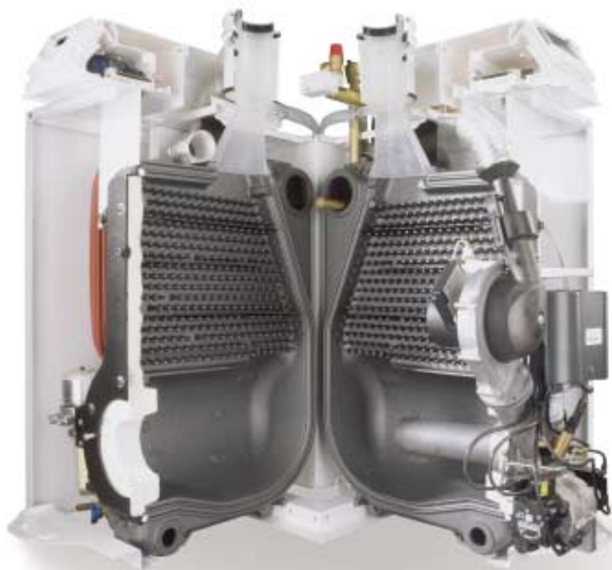
Schnittansicht des kompakten Ölkessels Logano plus GB135. Mit bis zu 99 Prozent auf Heizwert bezogenen Normnutzungsgrad kommt er, auch ohne Kondensation im Kessel selbst, auf etwa 93,4 Prozent Brennwertausbeute.
